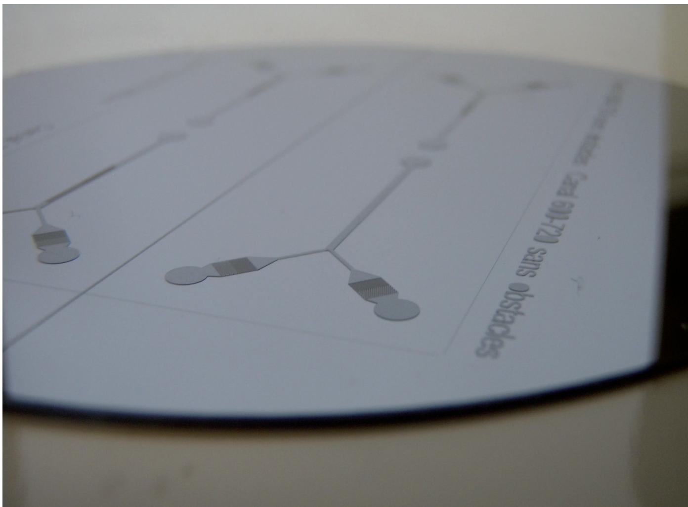
Circuit microfluidique sur disque de silicium. Permet l'étude du contact de deux fluides (eau et hydrocarbure). © Total PERL
