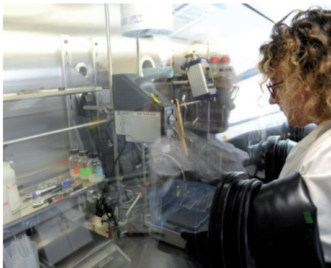
Expérimentations dans le cadre de la recherche pour la récupération améliorée du pétrole : manipulation de polymères en boîte-à-gants, cellule sans oxygène, laboratoires du PIC à Lacq. © Communauté des communes de Lacq et Orthez
