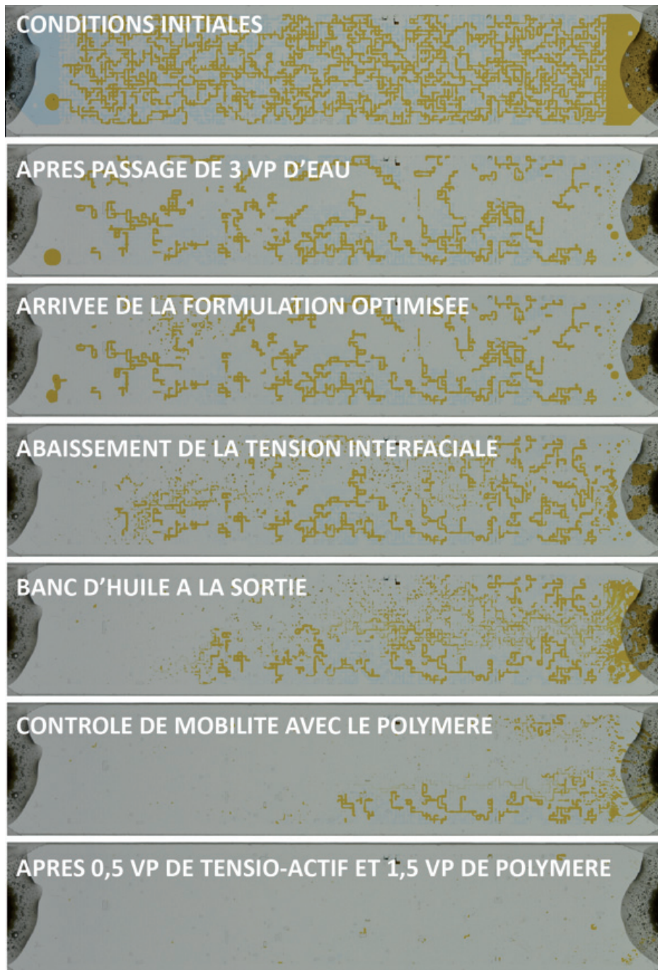
Visualisation en micromodèle de la récupération de pétrole. Injection des fluides de la gauche vers la droite. En fin de balayage, la quasi-totalité du pétrole a été récupérée. ©Total PERL
