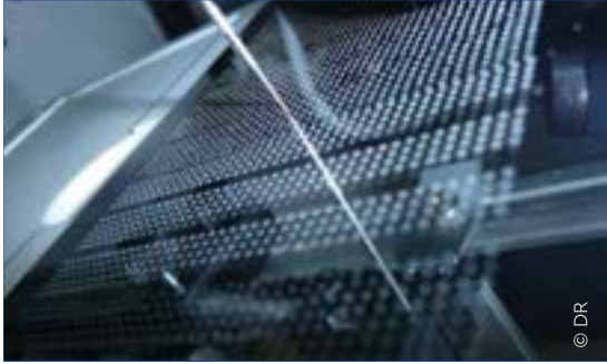
NanoLCMALDIsetup : La chromatographie en phase liquide est systématiquement miniaturisée dans des colonnes dont le diamètre interne ne dépasse pas 75µm. Les produits séparés sont alors collectés par de petits automates par fractions d'environ 40 µL sur cible MALDI (Matrix Assisted Laser Desorption ionization) comme sur l'image, ou en couplage avec la source nanoESI de façon plus classique.
