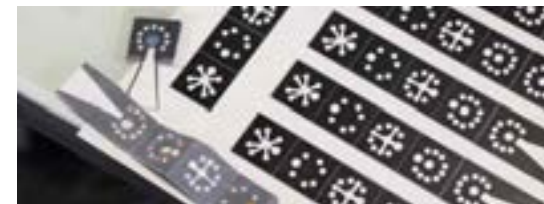
Des bandelettes de papier structurées à l'aide de canaux de cire comme tests sanguins. © Projet Lutétium
